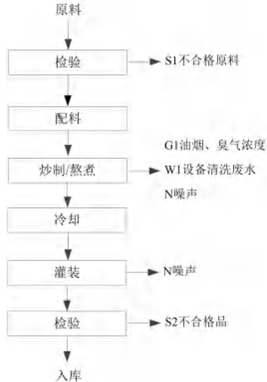
图 2-2 半固态调味品、调味油生产工艺流程及产污环节
